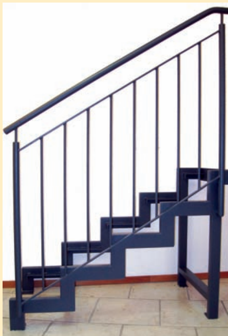
7: Pfosten aus Rundrohr 32 mm, Obergurt und Untergurt aus Flacheisen 30x8 mm, senkr. Füllstäbe 12 mm, Handlauf aus Rundrohr
