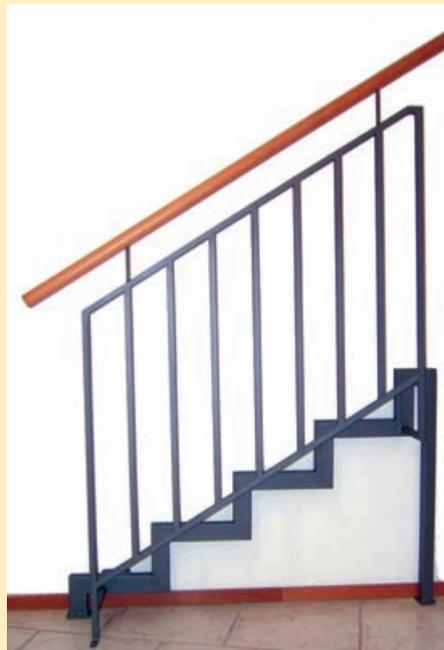
2: Obergurt und Untergurt aus Quadratrohr 20x20 mm, senkrechte Füllstäbe aus Quadratrohr 20x20 mm, aufgesetzter Handlauf in Holz
