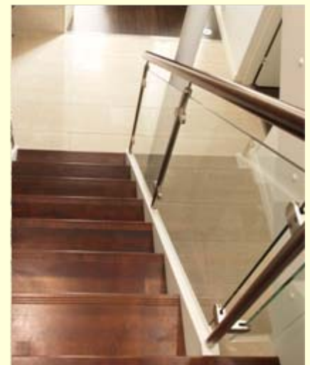
Podest-Treppe, eingestemmt offen in Birke massiv 50 mm Wangen weiß lackiert Stufen gebeizt Holzhandlauf HKR 50, Pfosten Edelstahl mit Glasfüllung
