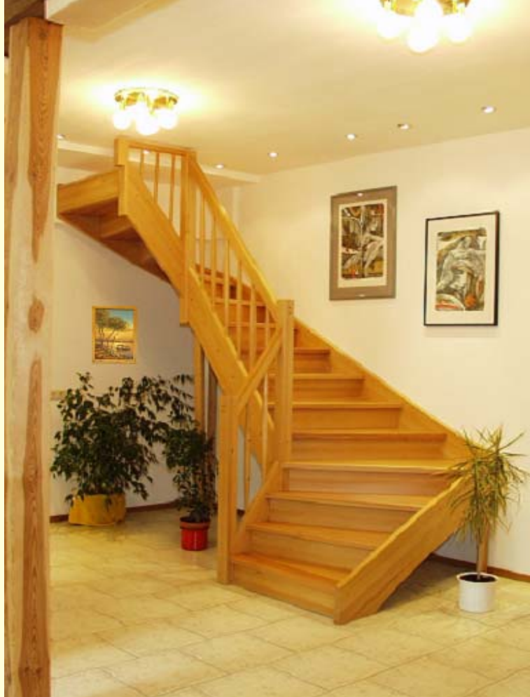
Treppe 2x1/4 gewandelt, eingestemmt geschlossen mit Stellstufen in Buche massiv 40 mm Handlauf HTK Geländer HS 3
