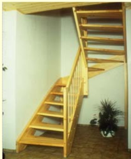
Treppe ½ gewendelt, eingestemmt offen, Kiefer massiv 40mm Handlauf HKM Pfosten HTK Geländerstäbe HS 23
