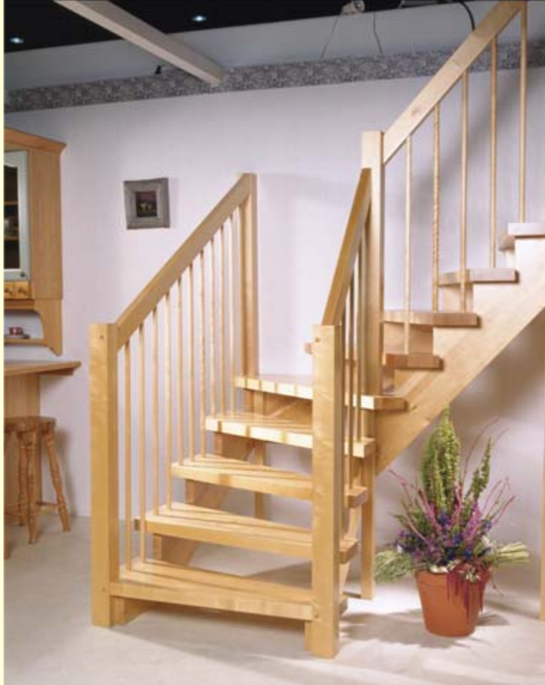
Treppe 1x1/4 gewandelt, aufgesattelt offen in Birke massiv 50 mm Handlauf HKM Pfosten HTK 80 Ge- länder HS 23
