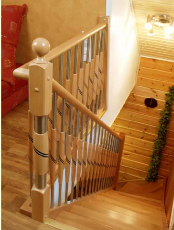
Treppe 1x1/4 gewendelt, eingestemmt offen in Buche massiv 40 mm Handlauf HKR 50 Pfosten HTS 12 Geländer S9 spezial
