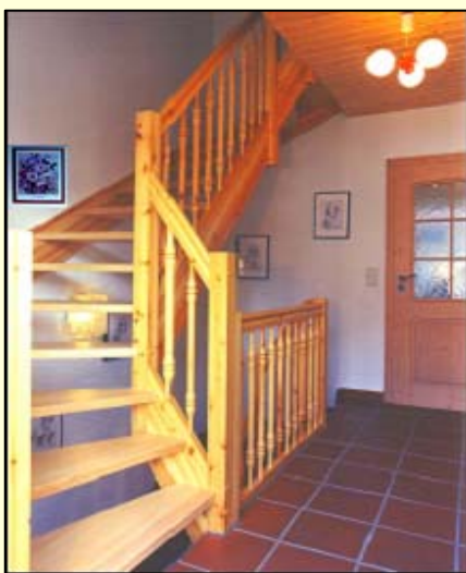
Treppe 2x1/4 gewendelt, eingestemmt offen, Wangen und Geländer in nordischer Kiefer 40 mm Stufen in Buche 40 mm Geländer HS 02
